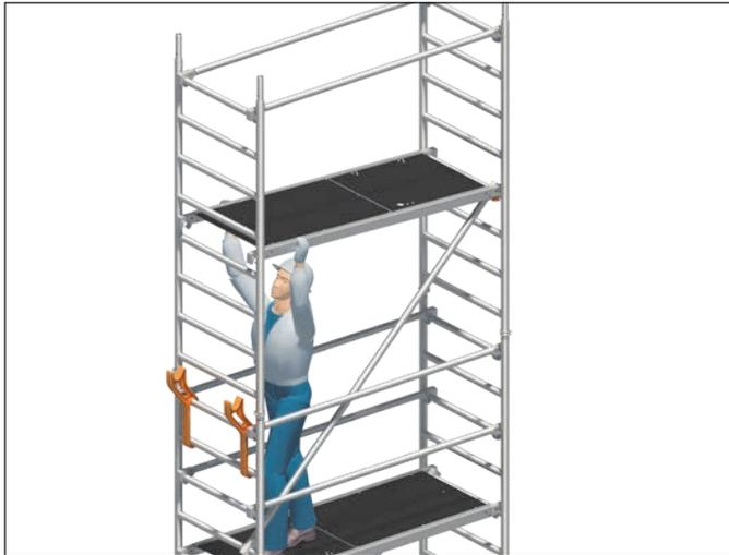
4. Diagonalen **18** und Durchstiegsbrücke **26** einsetzen. Die Diagonalen müssen auf beiden Seiten turmartig (Zick-zack-Form) eingebaut werden.
