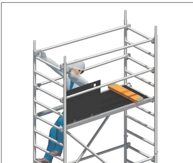
3a. In der Durchstiegsöffnung sitzend, absturzgesichert durch die Holme der Durchstiegsbrücke **26**, erfolgt das einseitige Lösen und Auflegen der Einrastklauwe von beiden Geländerholmen auf der Seite der Durchstiegsklauwe in 1 m Höhe über der Standfläche.
