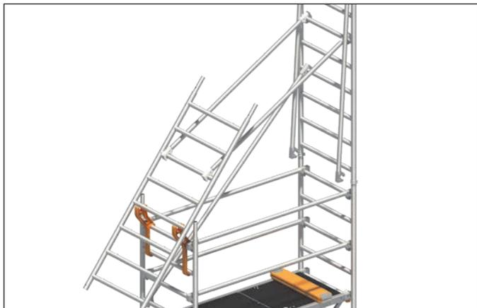
**7a.** Durch ein außenseitiges Vorbeiführen der oberen, bereits einseitig gelösten Geländer **15** an den oberen Enden der in den Uni Montagehaken **30** positionierten Standleiter werden diese in der späteren Ausbaulage positioniert.
