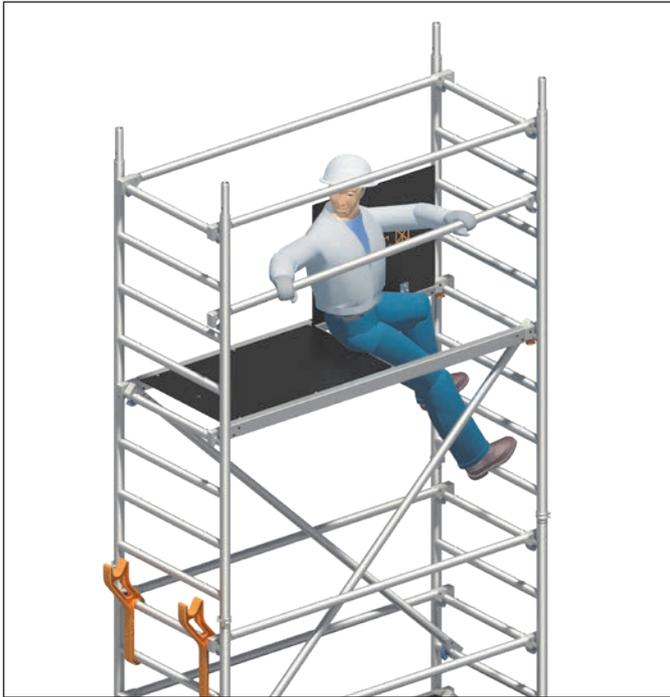
2. In der Durchstiegöffnung sitzend, absturzgesichert durch die Holme der Durchstiegsbrücke 26, erfolgt die Demontage der Zwischengeländer der jeweiligen Lage, hierzu werden die Geländer 15 an den zweiten Sprossen über der Standfläche demontiert. Sollten die Einrastklauen der Geländer 15 aus der sitzenden Position in der Durchstiegöffnung nicht erreichbar sein, erfolgt die Demontage wie unter 3a beschrieben.
