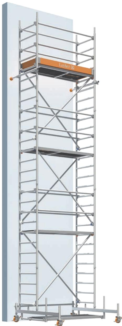
Für Arbeiten, die an einer tragfähigen Wand ausgeführt werden, kann die Ballastierung entsprechend der Tabelle **Ballastierung** (siehe Seite 10) reduziert werden. In diesem Fall sind auf beiden Seiten des Gerüsts Wandabstützungen oder Verankerungen einzubauen.
