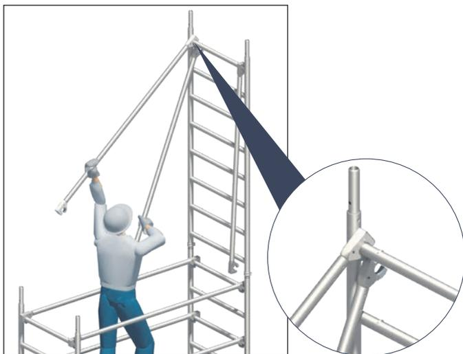
7. Demontage der Geländer **15** durch öffnen der Einrastklauwe mithilfe von einem der unter 3. demontierten Zwischengeländer. Das lose Geländer **15** wird auf die 2. Sprosse von oben aufgelegt und wirkt als Hebel zum Öffnen des Schließbügels der Einrastklauwe (siehe Detail).
