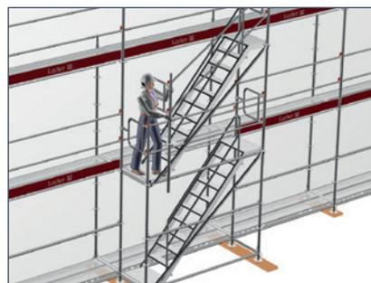
Mit dem modularen Fassadengerüstsystem AGS können auch vorgestellte Podesttreppentürme mit vorlaufendem Seitenschutz montiert werden. Treppenzugänge werden gemäß der TRBS 2121-1 erforderlich, wenn die Aufstiegshöhe 5 Meter überschreitet.
