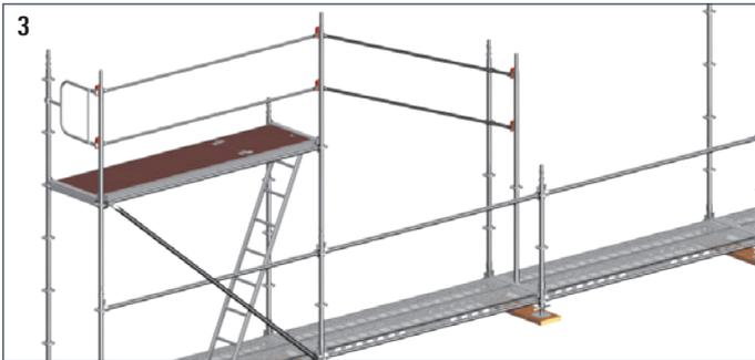
Nach oben schwenken, AGS-Stiel aufstecken, U-Riegel einbauen und Boden einhängen. In gleicher Art und Weise kann das gesamte Fassadengerüst sicher montiert werden. Die Demontage erfolgt in umgekehrter Reihenfolge.
