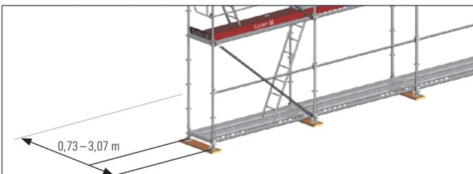
Wenn z. B. für Bewehrungsarbeiten größere Arbeitsflächen notwendig sind, kann durch den Einsatz von Standard U- oder O-Riegeln die Gerüstbreite bis zu 3,07 m frei gewählt werden.
