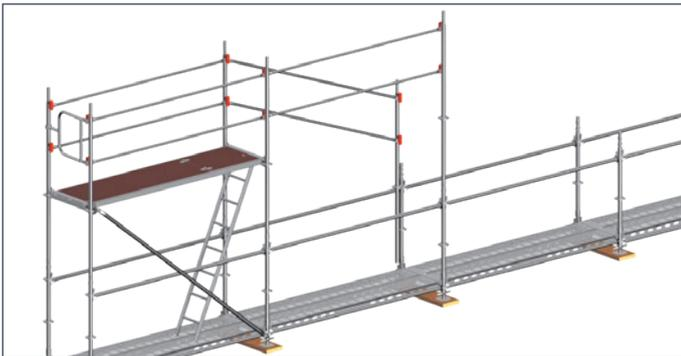
Der AGS-Stiel erlaubt sowohl eine vorlaufende Geländermontage nur an der Gerüstaußenseite als auch beidseitig. In diesem Fall wird auch an der Gerüstinnenseite zur Fassade hin, analog zur Gerüstaußenseite, mit einem 1-Meter-Stiel begonnen. Die weitere Montage erfolgt identisch zur Aufbauvariante 1.
