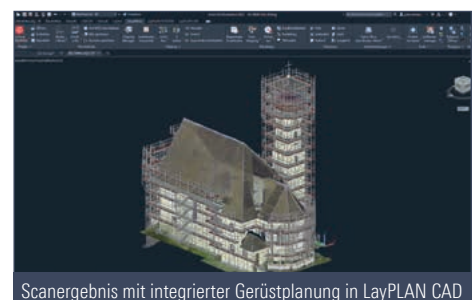
Punktwolke des Außenbereichs einer Kirche
